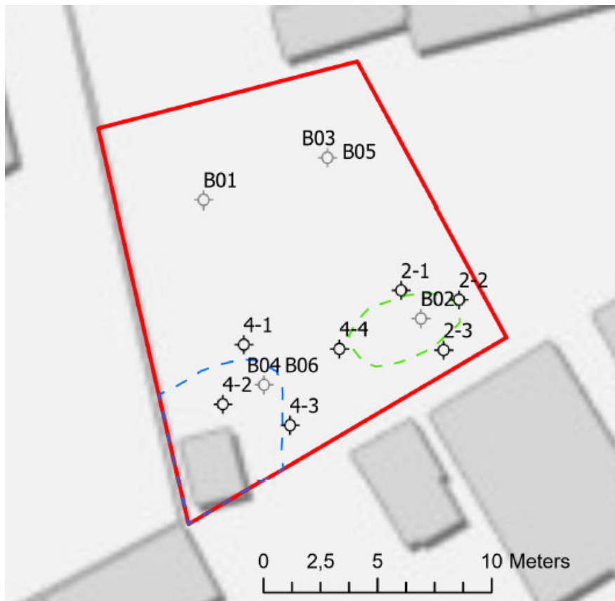
Figuur 1: Verontreinigingscontour zink spots. De blauwe contour betreft de spot in de bovengrond (0,0-0,5m -mv.) rond B04. De groene contour betreft de spot in de ondergrond (0,5-1,0m -mv.) rond B02.
