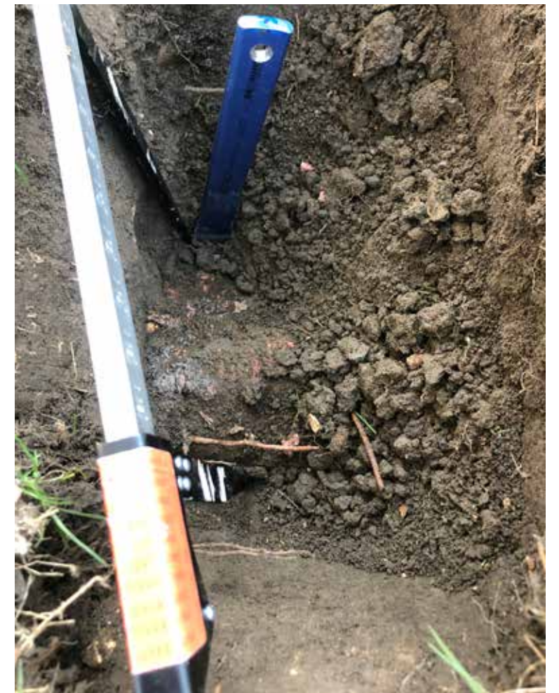
De dikke wortel (20 cm) ter plaatse van het geplande voetpad mag beslist niet worden verwijderd. Aanpassing van het plan wordt geadviseerd.
